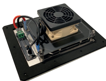
Membrane 7 x 7 sur son support avec ventilation pour le brassage de l'air
