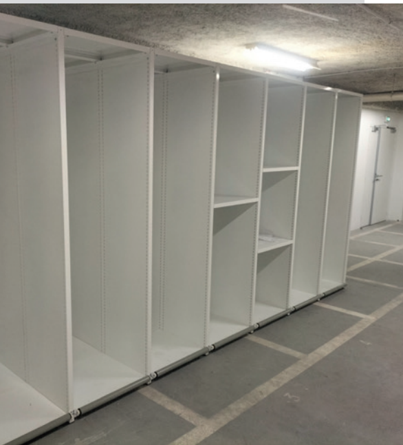
Rack à tableau composé d'un module départ et de six modules suivants, avec 3 étagères de division pour la création de plus petits casiers
